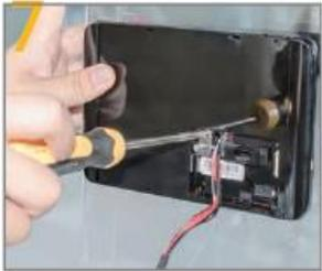
7 Затяните болты и закрепите внутреннюю часть
