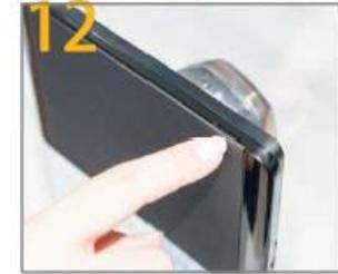
12 При открывании задней крышки используйте изгибы на внутренней части
