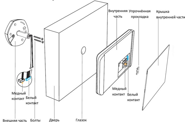
Вкрутите соответствующие болты во внешнюю часть, снимите с её задней стенки защитную бумагу из вязкой пены, распрямите провод и проведите провод и внешнюю часть через отверстие в двери (для протягивания провода через отверстие в двери можно использовать свёрнутый в трубку лист бумаги). Закрепите внешнюю часть, затем затяните болты и закрепите внутреннюю часть. После этого соедините белые и медные контакты. Установка завершена
