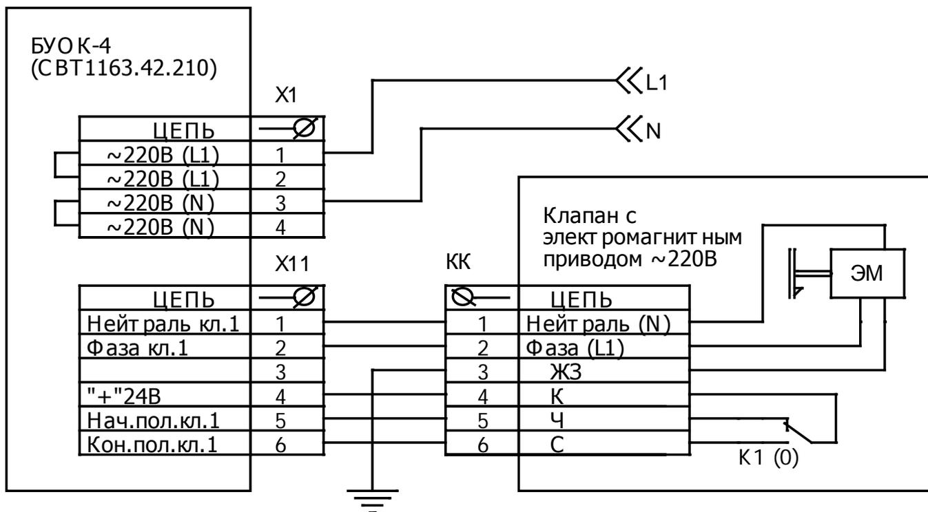
**Рис. 7. Схема подключения клапана с электромагнитным приводом (~220В)**
