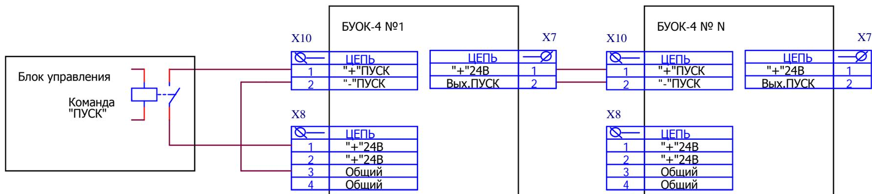
Рис. 10. Схема подключения группы БУОК к устройству, формирующему команду управления
