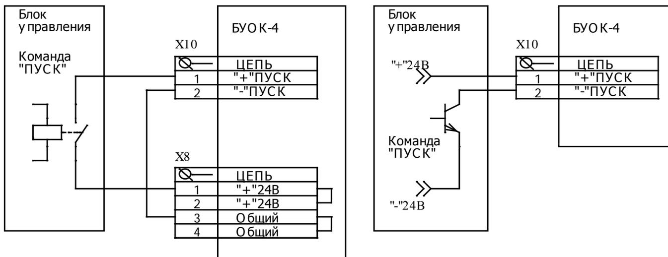
Рис. 9. Схема подключения устройства, формирующего команду управления
