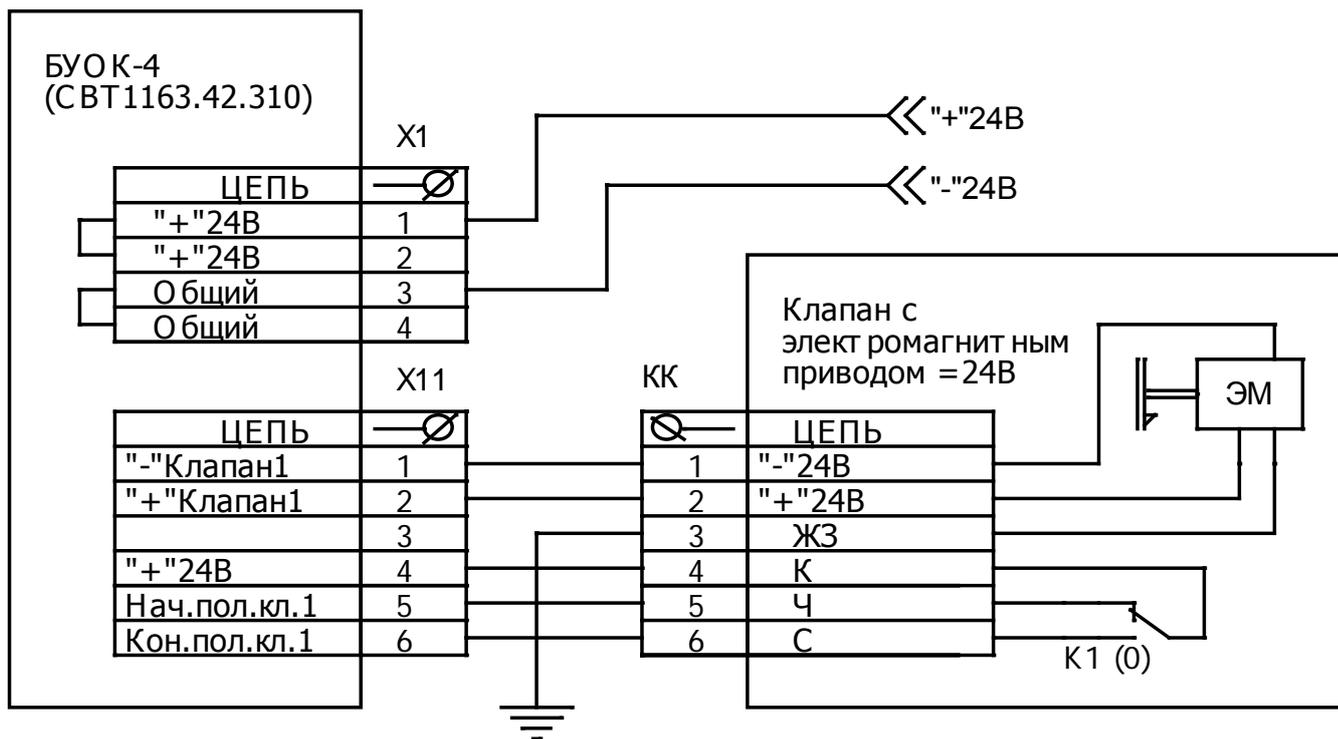
Рис. 8. Схема подключения клапана с электромагнитным приводом (=24В)
